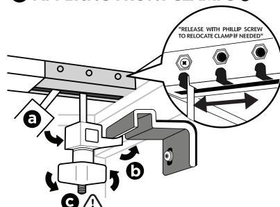
PULL DOWN FRONT CLAMPS INTO VERTICAL POSITION.
