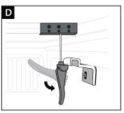
D: LATCH THE JAW GROOVE FULLY INTO THE RAIL LIP, THEN CRANK HANDLE DOWN TO TIGHTEN. GO BACK AND READJUST JAW POSITION FROM STEP B IF THE LATCH DOES NOT FEEL VERY TIGHT.
