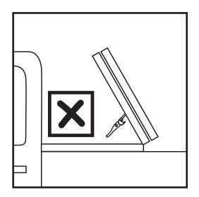
• REAR LATCHES MUST BE TUCKED IN BEFORE YOU FOLD BACK THE COVER.
