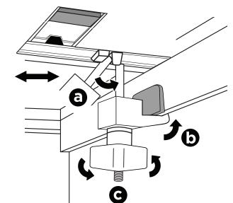
PULL DOWN FRONT CLAMPS INTO VERTICAL POSITION.
