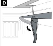
D: LATCH THE JAW GROOVE FULLY INTO THE RAIL LIP, THEN CRANK HANDLE DOWN TO THE THEN GO BACK AND READJUST JAW POSITION FROM STEP B IF THE LATCH DOES NOT FEEL VERY TIGHT.
