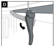
D: LATCH THE JAW GROOVE FULLY INTO THE RAIL LIP, THEN CRANK HANDLE DOWN TO TIGHTEN. GO BACK AND READJUST JAW POSITION FROM STEP B IF THE LATCH DOES NOT FEEL VERY TIGHT.
